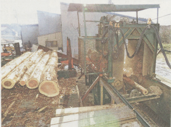
ペレット製造の最初の工程となる丸太の皮むき
