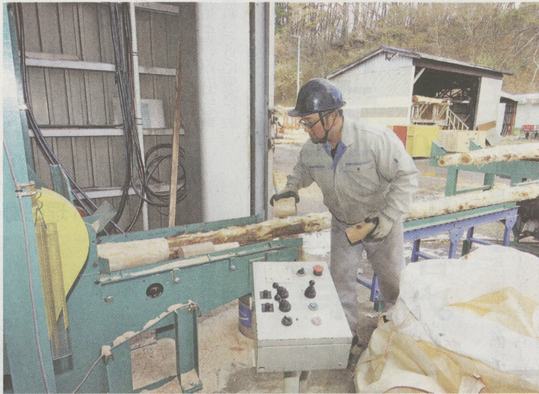
丸太の皮をむき、破碎する作業に当たる「高橋」の従業員
