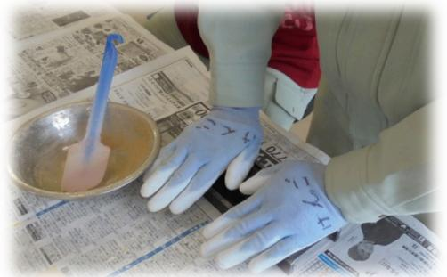
⑤【型枠に蓋をし、強く押し込みます】
